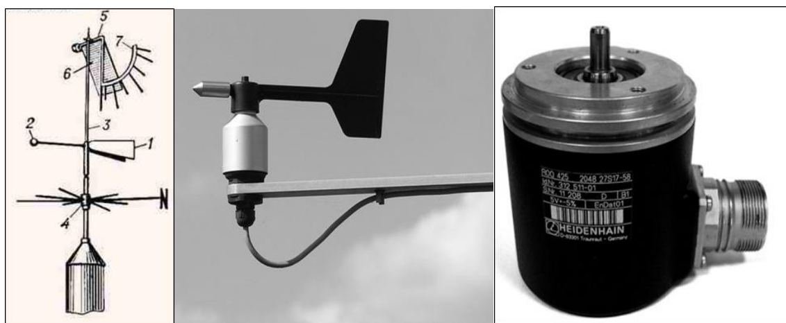
Рисунок 4. Флюгер: а) модель 1968 г ; б) современная модель; в) датчик угла поворота.
